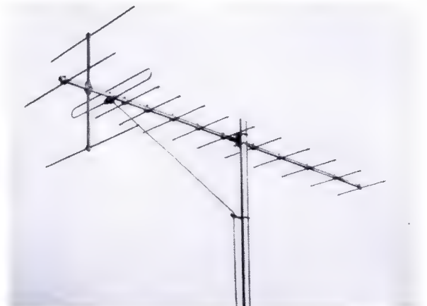
Bild 2. Hochleistungs-Breitband-Antenne Fesa 14 F. Sie ist durch Biegeenden auf das gesamte Fernsehband III oder auf die untere oder die obere Bandhälfte abstimbar
