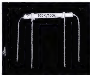
Bild 2. Praktische Ausführung einer RC-Kombination
