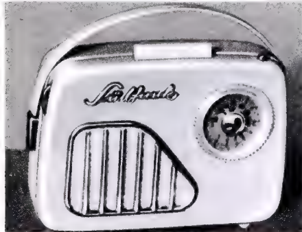
Bild 1. Südfunk-UKW-Koffer K 986 — einer der ersten serienmäßigen Reiseempfänger mit UKW-Transistoren
